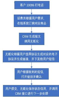
图12 外呼推送H5链接实现流程
