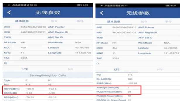
图7 Mate20X终端发射功率
