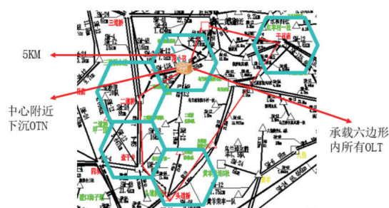
图 3 OTN“微蜂窝”式下沉示意图
