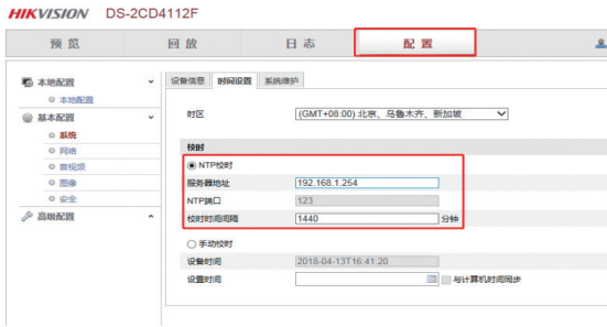
图6 海康摄像头配置界面 爱普配置示例如图7所示：
